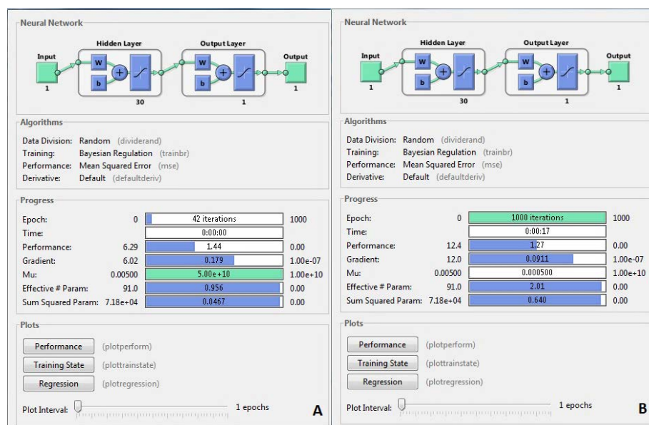
Figura 5 (a): Rede com término do treinamento em 42 iterações; (B) Rede com término do treinamento em 1.000 iterações
